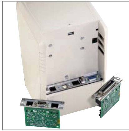
AUSTAUSCHBARE SCHNITTSTELLEN Seriell, Parallel, USB und LAN
